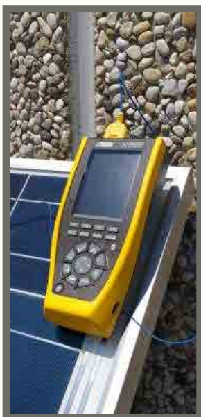
Temperaturmessung an Solarmodulen. Mit der praktischen Multifix-Magnethalterung als Zubehör hat man die Hände frei zum Arbeiten.
