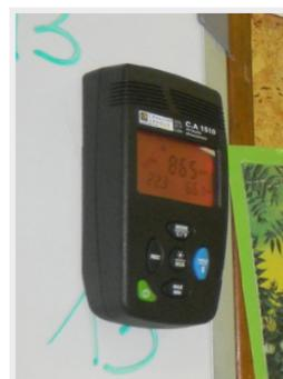
**Mehrere Befestigungsarten:** mit Magnet, über verschließbare Wandhalterung, Tischhalterung oder hängend an der Wand.
