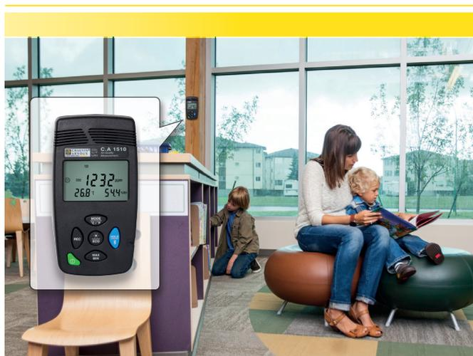
**Der C.A 1510 misst den CO<sub>2</sub>-Gehalt** entsprechend den neuesten gültigen Vorschriften, die die Bewertung von Lüftungssystemen und die Messung von Schadstoffen in der Raumluft in öffentlich zugänglichen Räumen regeln. Sobald die CO<sub>2</sub>-Konzentration in der Raumluft im Mittel 1000 ppm oder Spitzenwerte von 1700 ppm erreicht, gibt der **C.A 1510** eine optische und akustische Warnung ab.
